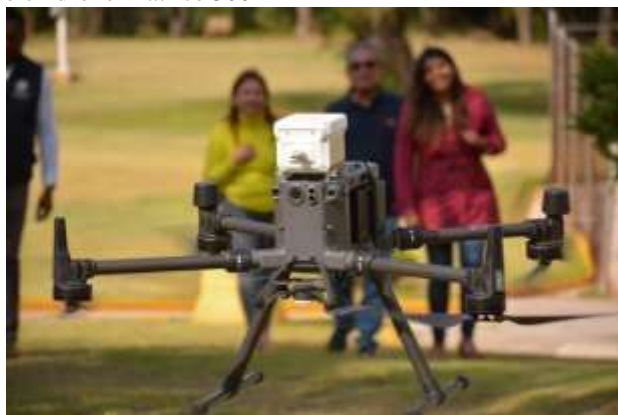
Imagen 3. Sniffer montado en drone Matrice 300
